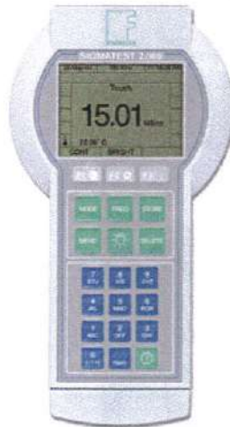
Gambarajah 5: Alat pengukur kekonduksian menyelesaikan keraguan mengenai jenis suatu bahan
