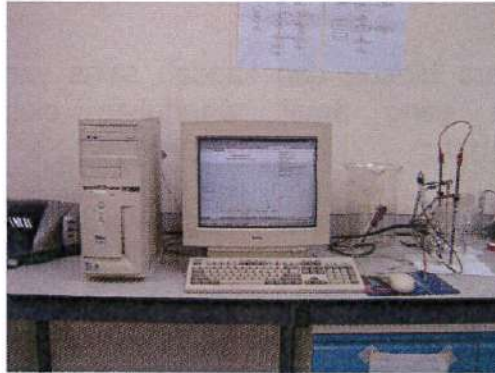
Gambarajah 7: Peralatan Pengukuran Kuantitatif Kakisan Elektrokimia
