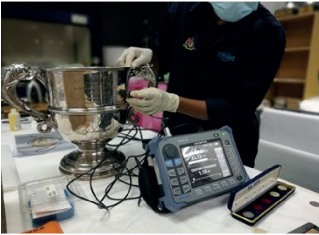
Penyelidikan Trofi HMS Malaya menggunakan Teknik Eddy Current Testing oleh Agensi Nuklear Malaysia
