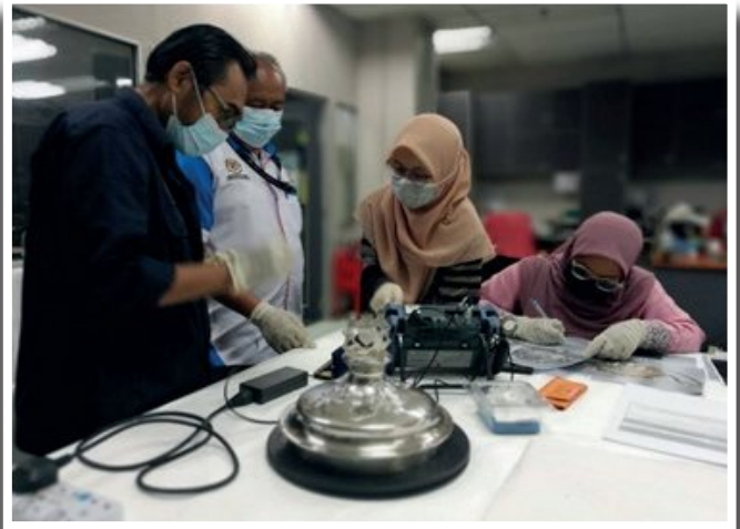
Penyelidikan Trofi HMS Malaya menggunakan Teknik Eddy Current Testing oleh Agensi Nuklear Malaysia
